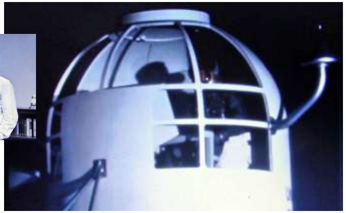
Den första testmodellen av månlandaren hos Grumman, 1961
